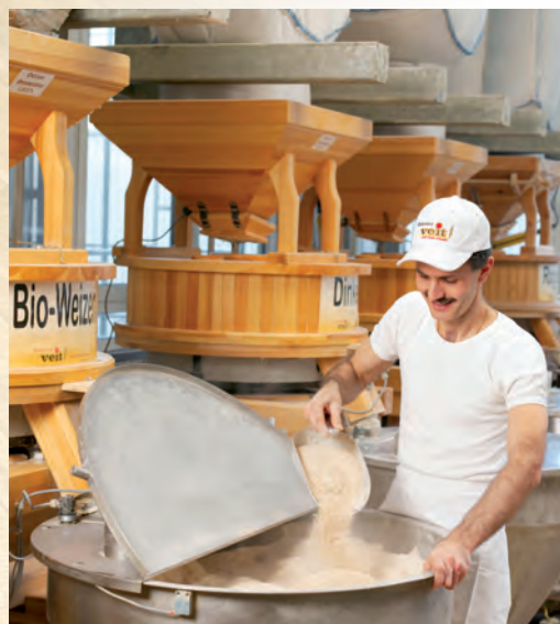
In der Produktion hat das Bäckerhaus Veit vier Tiroler Steinmühlen im Einsatz.
